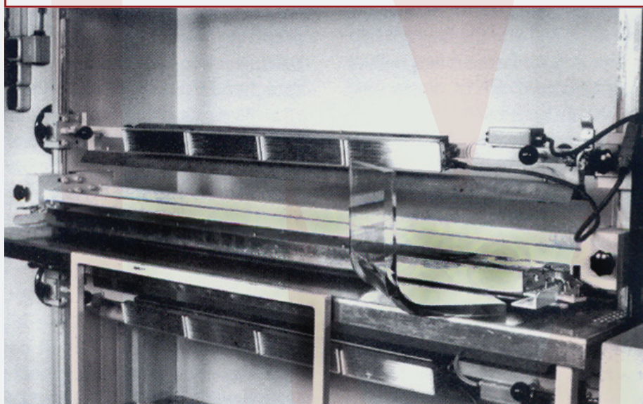
6. ábra: élhajlító különféle IR sugárzóval és élhajlított PLEXIGLAS® elem
