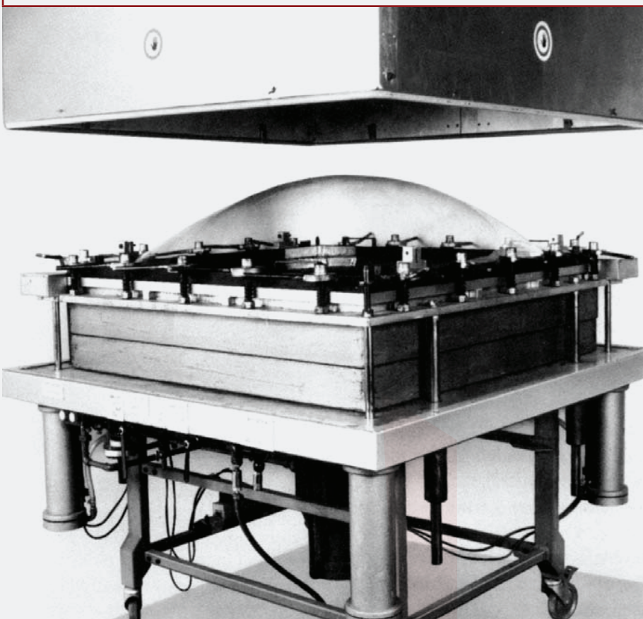
23. ábra: Felülvilágító kupola prés légformázása ellendarab nélkül
