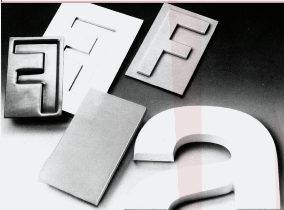
20. ábra: PLEXIGLAS® GS-ből nyomással készített betűk, alumínium formszerszámmal és szilikongumi lemezzel
