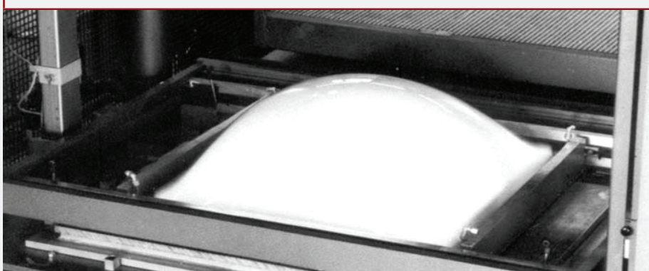
c: vákuumformázást követően
