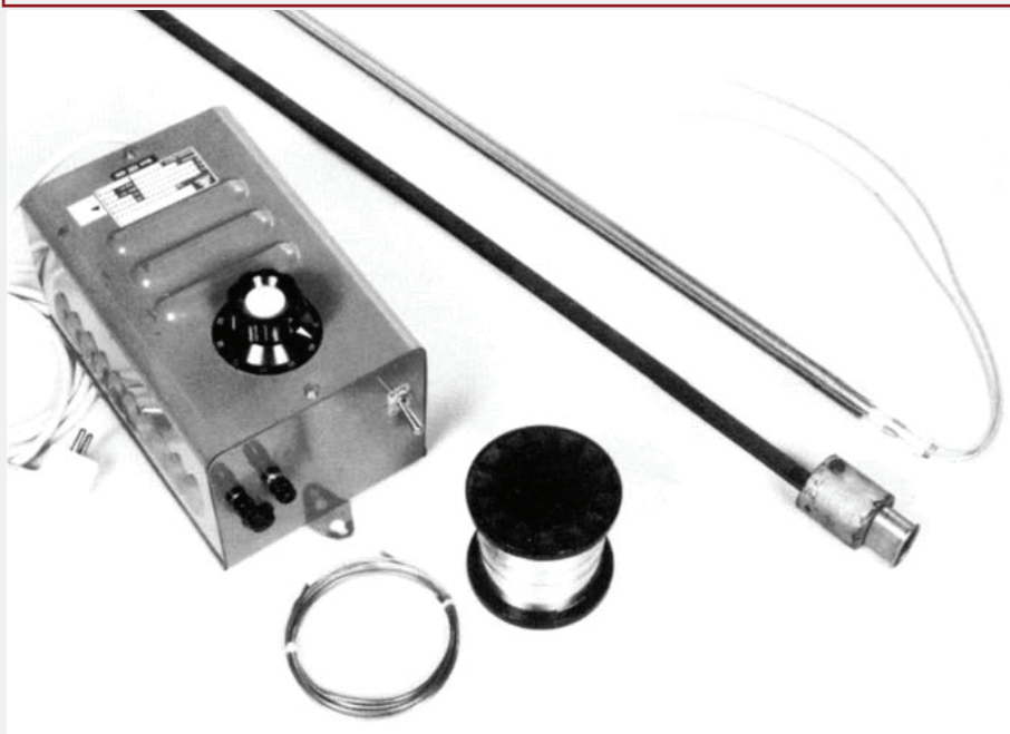
7. ábra: fűtőszálak transzformátorral, fűtőrud és kvarccső
